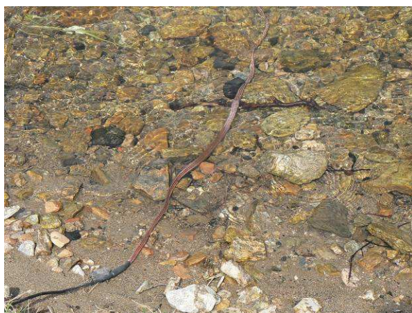
Cliché 63. Cathode sous forme de tresse d'un appareil de pêche électrique – FDPPMA43 © Arnaud Tanguy
